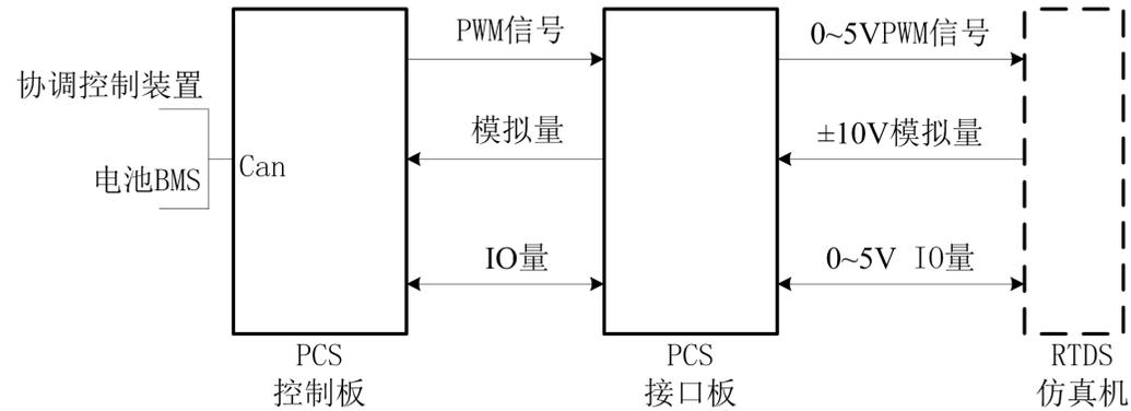
图 1 储能 PCS 控制器系统架构图
